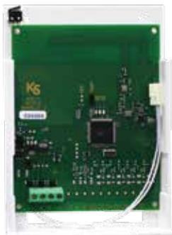
duo16 BUS permette di espandere la serie di centrali lares16 e lares16 IP, gestendo fino a 16 dispositivi wireless ciascuno, e fino a 16 zone wireless e 8 telecomandi per l'intero sistema. Fino a due ricevitori possono essere collegati al bus, entrambi per espandere la copertura del segnale e per funzionare da backup a vicenda.
