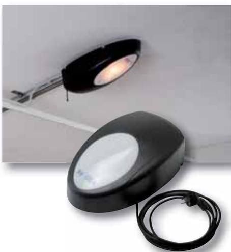
Motore Spazio 24VDC, con portata di 60 Kg, quadro di comando e ricevitore radio 433 MHz 2 canali incorporati, regolazione di velocità e rallentamento in apertura e chiusura, sensore antischiacciamento standard, luce di cortesia per illuminare l'area di manovra. Fornito con guida a catena in lunghezza standard da 3100 mm e 3600 mm, se necessario disponibili ulteriori prolunghe.
