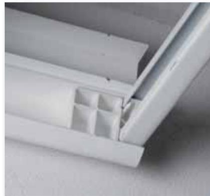
⑨ Inserto angolare per il fissaggio a incastro della dima posteriore con le guide orizzontali: evita le operazioni di foratura e di montaggio delle viti, essendo inserito a pressione; migliora l'estetica, non essendo visibile a montaggio completato.
